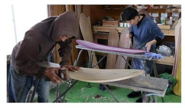
雪板製作は板を成形するところから 始めます。 板に水を吸わせて熱する と曲げられるようになるので、専用の 型枠で反りをつけていきます。秋田県 の「曲げわっぱ」と同じ要領です。
