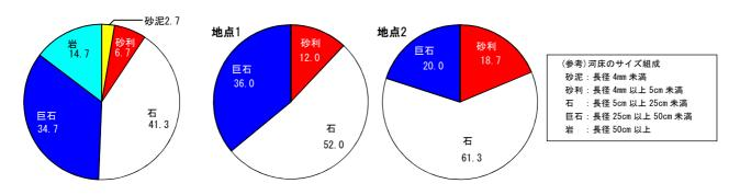
図2 寒河江川慈恩寺橋付近における工事前と工事後の河床のサイズ組成(%)。各 n=75
