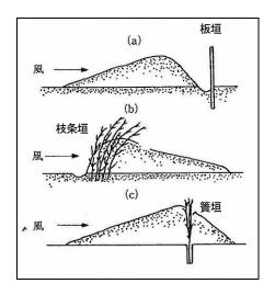
図3 堆砂垣の種類と砂の堆積のパターン (林野庁「治山技術基準」)
