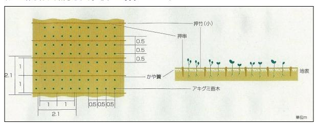
図6 覆砂工施工図 (伏工及び静砂木植栽施工図)
