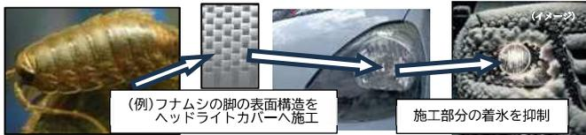
フナムシの脚は優れた水分の瞬時拡散機能、撥水機能等を有しており、その形状を模倣 (バイオミメティクス) した製品開発。
