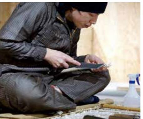
専用の刃物・サルキリを材料となる木に当て、手作業で繊細な彫りを施す 笹野一刀彫。常に大怪我のリスクと隣り合わせである。
