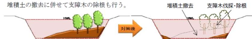
②主に中規模河川で高水敷等の支障木が河積を阻害している箇所
