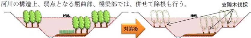
③主に中規模河川で低水路の堆積土が河積を阻害している箇所
