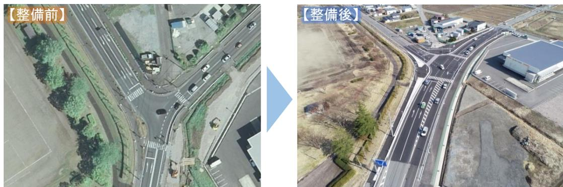
図 3-12 地域の実情に応じた道路改良の事例(交差点改良及び現道拡幅)
