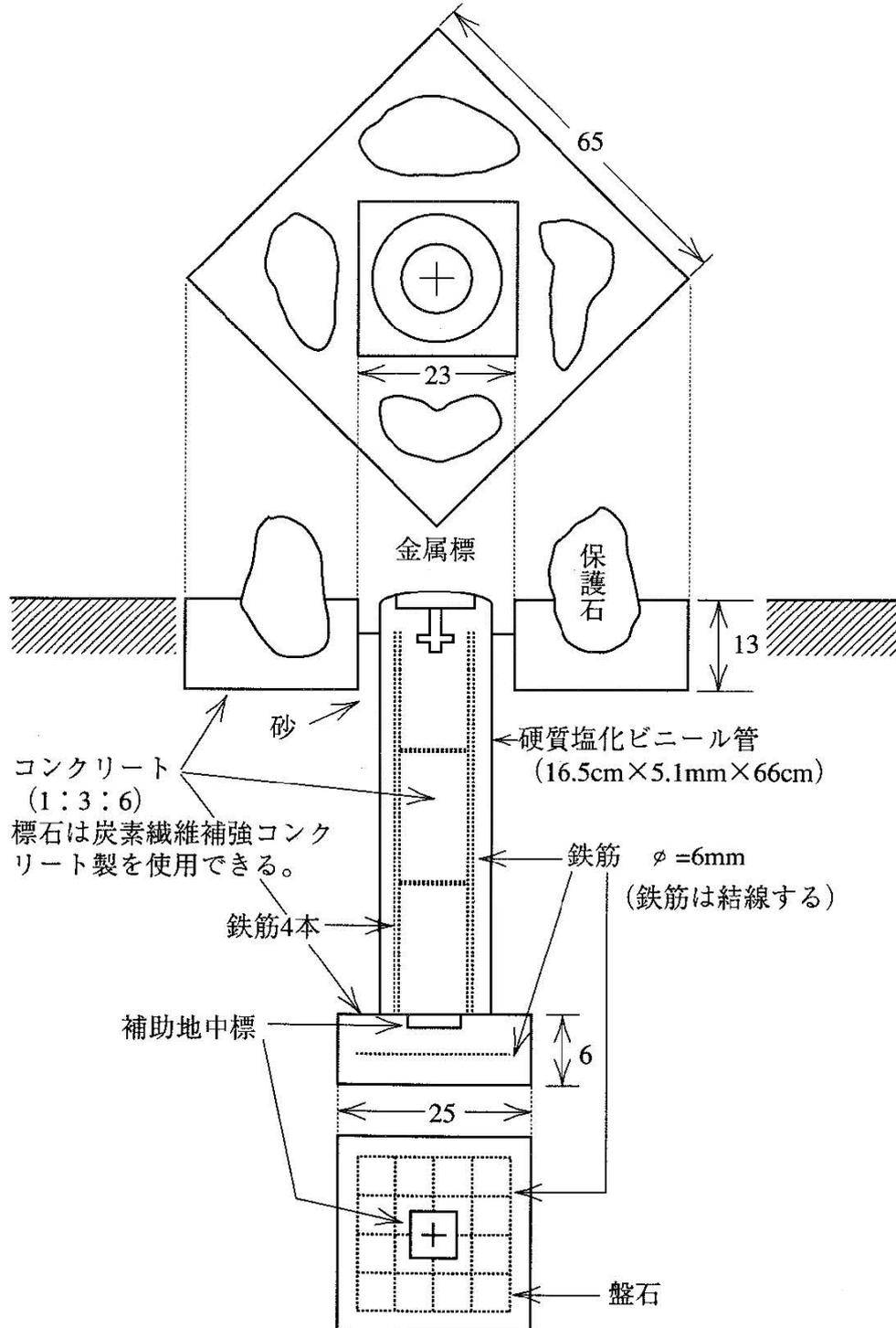
2) 基準点（金属標）地下埋設図
