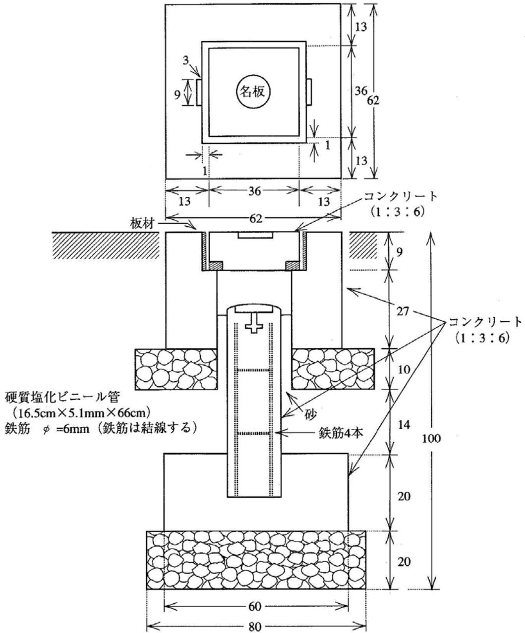
8) 水準点（金属標）3・4級地下埋設図
