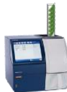
近赤外線分光分析装置 (非破壊で効率的に食味成分含有量を測定)
