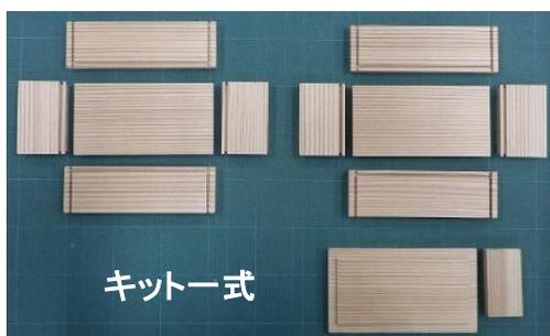
木材は、県内でも有数の林業地である鶴岡市温海地域で生産された「あつみ杉」の、特に高級材として用いられる部分である、柾目（まさめ）材を使用しています。材料はキット化されており、あらかじめ加工された「ほぞ」を組み継ぎ、木釘を使用して固定する、「指物（さしもの）」の技術を用いて製作します。塗料は、「柿渋（かきしぶ）」または「くるみ」等の天然素材を使用します。
