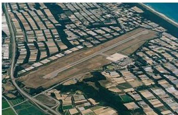
A320型機による東京・大阪それぞれ1往復/日でスタートしたが、東京便は、高い搭乗率が続いたことから平成4年11月に2往復/日に増便された。その後中型ジェット機が就航できるよう平成5、6年にターニングパット（180度回転部）・誘導路の拡幅、エプロンを拡幅し、平成6年度から中型ジェット機B767-200型機が就航した。
