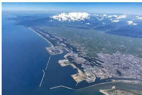
平成 7 年 5 月には、韓国・釜山港との間にコンテナ定期航路が開設され、平成 25 年にはコンテナクレーンを 1 基増設し、コンテナクレーンが 2 基体制となったことや民間企業の精力的な事業展開等から、平成 26 年からコンテナ貨物取扱量が急増していた。そのため、それに対応したコンテナヤード拡張、コンテナターミナル設備の拡充、コンテナクレーンの更新・大型化、臨港道路の拡幅等の施設整備を推進し、令和 2 年 8 月に 150m 岸壁延伸とコンテナヤード拡張部を供用開始した。
