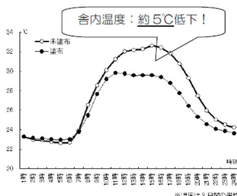
ドロマイト石灰塗布による屋根裏温度の推移
