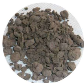
写真 2-5 下水汚泥固形化燃料
