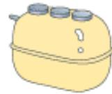
浄化槽には、トイレの汚水だけを処理する単独処理浄化槽と、トイレの汚水のほかに台所、風呂、洗濯などの排水（＝生活雑排水）も合わせて処理する合併処理浄化槽の2種類があり、単独処理浄化槽の家庭は合併処理浄化槽の約8倍汚れた水を流していることになります。
