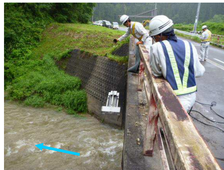
採取位置②(河床)の流砂採取状況
