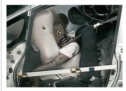
エアバッグは、衝突時に乗員の被害を軽減する安全装置ですが、成人の体型を前提に設計されているため、体が小さい子供には、適切に機能しないことや、被害を大きくすることがあります。
