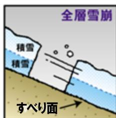
**全層雪崩**はすべり面が地面であり、時速40~80kmの速さで滑り落ちます。
