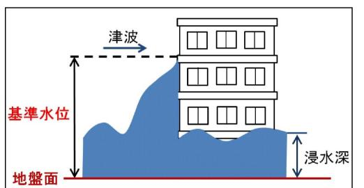
【地形(標高)データ】 〇 基準水位の算出に用いた「地形(標高)データ」 は、平成25年度から平成26年度に実施された航空レーザー測量、基盤地図情報等の結果 を基に作成しているため、その後の開発に伴う 盛土や個別施設の微細な土地の形状が現況 と異なっている場合があります。
