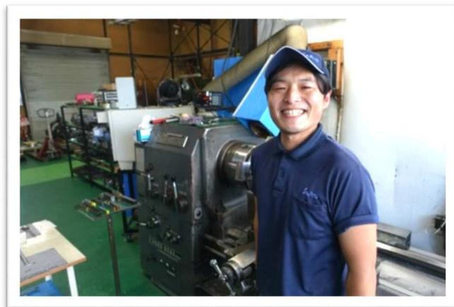
汎用旋盤という機械を使って、ステンレスとか銅、アルミニウムといったいろいろな材料を、図面の通りに加工していく仕事です。お客様から依頼いただいた図面があり、それをもとに機械で加工します。
